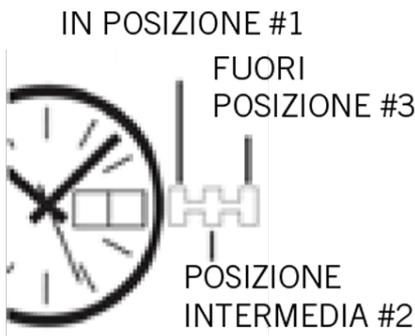
1. Estrarre la corona di regolazione portandola nella posizione #3. Ruotare la corona per spostare le lancette in avanti. Quando le lancette superano le 12, controllare la data. Se la data cambia, l'orologio segna la mezzanotte. Regolare le lancette in modo da impostare l'indicazione A.M. o P.M. Premere la corona per riportarla nella posizione #1.
