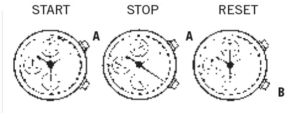
3. Per usare il cronografo premere una volta il pulsante situato a ore 2. La lancetta dei secondi inizia il conteggio. Per fermare cronografo, è sufficiente premere per una seconda volta il pulsante situato a ore 2.
