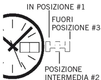
1. Estrarre la corona di regolazione portandola nella posizione #3. Ruotare la corona per spostare le lancette in avanti. Quando le lancette superano le 12, controllare la data. Se la data cambia, l'orologio segna la mezzanotte. Regolare le lancette in modo da impostare l'indicazione A.M. o P.M. Premere la corona per riportarla nella posizione #1.
