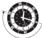
如果您的手表配有一个可旋转的外置分钟刻度表盘，这可以用于计算各种各样方式的消耗时间。例如：如果潜水员有30分钟供气，当他下潜前可以设定表壳的外圆环，使圆环上三角型对准分针，然后分针指着在外圆环上的数字便是潜水员在水底的逗留时间。
