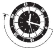
お客様の時計の外周に、分単位の回転式ダイヤルが備え付けられている場合は、様々な方法で経過時間の測定が可能です。例えば、30分間分のエアタンクでダイバーが潜水する場合、潜水開始時に三角形を分針に合わせるよう外側のリングを設定します。分針が示している外側リングの位置によってダイバーが何分間水中にいるのかが分かります。
