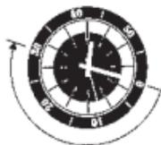
Se l'orologio è dotato di una lunetta esterna girevole con graduazioni di un minuto, potrà essere utilizzato in vari modi per controllare il tempo trascorso. Ad esempio, se un tuffatore ha una riserva d'aria di 30 minuti, potrà posizionare la lunetta esterna in modo da allineare il triangolo con la lancetta dei minuti durante l'immersione. La lancetta dei minuti, quindi, indicherà su la lunetta la durata dell'immersione del tuffatore.
