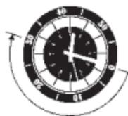
Si votre montre est équipée d'une lunette tournante unidirectionnelle rotative, elle peut être utilisée de diverses façons pour vérifier le temps écoulé. Par exemple, un plongeur ayant une alimentation en air de 30 minutes peut régler la lunette extérieure en plaçant le triangle (point 0) vis à vis de l'aiguille des minutes au moment où il plonge. L'aiguille des minutes indiquera alors sur la lunette extérieure depuis combien de temps le plongeur est sous l'eau.
