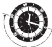
Se o seu relógio está equipado com um anel exterior rotativo com marcas de um minuto, poderá usar esta peça de várias formas para verificar o tempo decorrido. Por exemplo, se um mergulhador tem reserva de ar para 30 minutos, poderá ajustar o anel exterior, de forma a que, quando mergulha, o triângulo esteja alinhado com o ponteiro dos minutos. O ponteiro dos minutos indicará no anel exterior o tempo que o mergulhador está debaixo de água.
