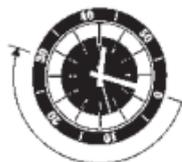
Wenn Ihre Uhr mit einem drehbaren Außenring mit Minutenskala ausgestattet ist, kann dieser Ring in verschiedener Weise zur Erfassung der abgelaufenen Zeit benutzt werden. Hat ein Taucher beispielsweise einen Atemluftvorrat für 30 Minuten, kann er den Außenring so einstellen, dass die dreieckige Markierung (0 Position) mit dem Minutenzeiger übereinstimmt, wenn er eintaucht. Der Minutenzeiger zeigt dann auf dem Außenring die Verweilzeit des Tauchers unter Wasser an.
